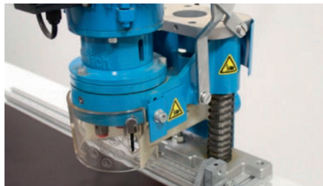
Рис. 4: Передвижное защитное стекло у сверлильных шпинделей
